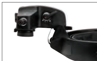
Flip-up-funksjon av optikkenheten
